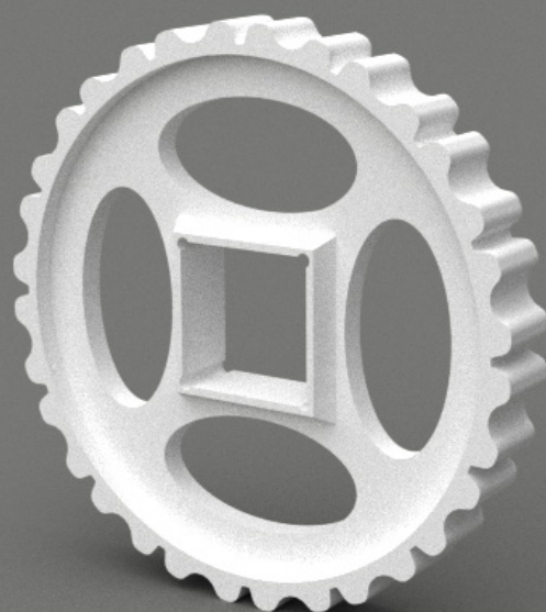
Diámetro Primitivo 255 mm
